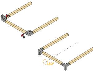
03 Montar as sapatas e os porta-pilares nas vigas como indicado
