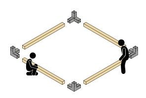
Montar primeiro os três elementos (de modo a formar um U)
