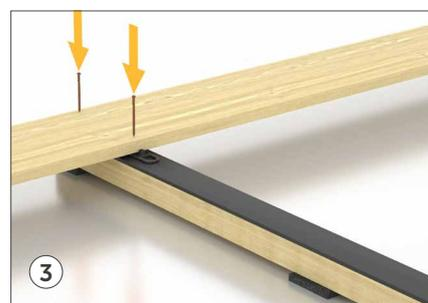
3 Primeira tábua: colocar a primeira tábua sobre os SNAP, criando assim a ventilação correta entre a ripa e as tábuas; fixar com parafusos adequados deixados expostos.
