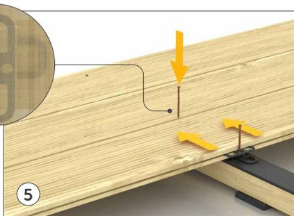
5 Posicionar a tábuas seguinte, inserindo-a no conector SNAP. Apertar as tábuas usando o estreitador CRAB MINI até obter uma fuga entre as tábuas de 7 mm. Fixar os conectores com os parafusos à ripa subjacente.
