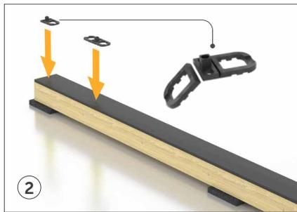
2 Utilizando os entalhes apropriados, quebrar o SNAP e posicioná-lo perto da borda da ripa. Posicionar os outros SNAP ao longo do comprimento da ripa.
