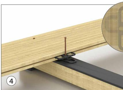
4 Posicionar o SNAP de modo a que o pescoço entre totalmente em contacto com o pescoço do outro SNAP posicionado por baixo da tábuas. Fixá-los, inserindo um parafuso MINI no orifício central do SNAP superior. Por enquanto, NÃO aparafusar.
