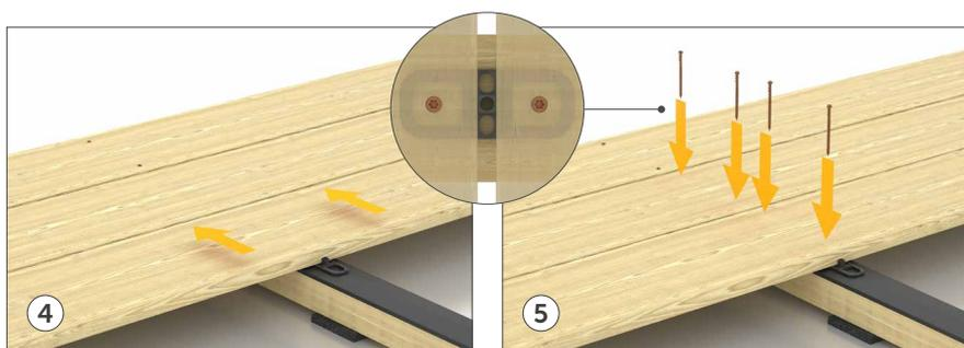
4 Posicionar as tábuas seguintes apoiando-as nos SNAP colocados ao longo das ripas. Apertar as três tábuas utilizando o estreitador CRAB MINI, até obter uma fuga de 7 mm.
