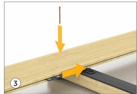
3 Primeira tábuas: colocar a primeira tábuas sobre os SNAP, criando assim a ventilação correta entre a ripa e as tábuas; fixar com parafusos adequados deixados expostos ou inseridos ocultos com a ajuda dos acessórios apropriados. Inserir o segundo conector SNAP na ranhura com o pescoço virado para baixo.
