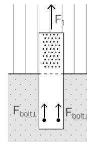
Der Anker nachweis ist erbracht, wenn die Zugtragfähigkeit unter Einbeziehung der Randwirkungen größer ist als die Bemessungslast:
