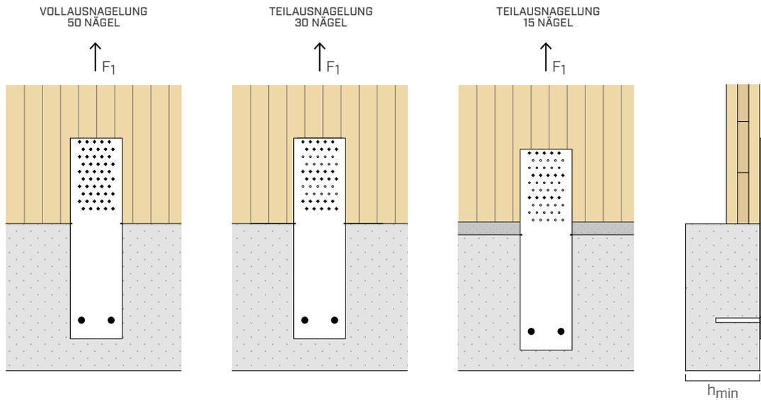
MINDESTBREITE BETON  $h_{min} \geq 200 \text{ mm}$
