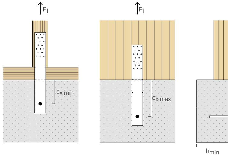
MINDESTBREITE BETON  $h_{min} \geq 200$  mm
