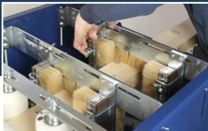
Calibratura delle spazzole* per una finitura ottimale.
