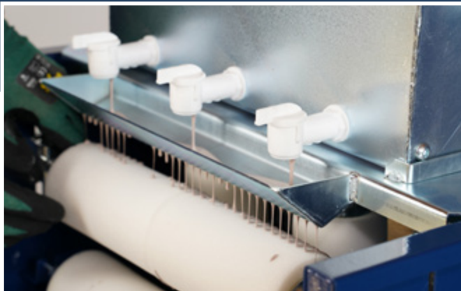
Praktische Düsen mit Öffnung per Hahn, um die zum Tränken der Schaumstoffrollen* benötigte Farbmenge zu regeln.
