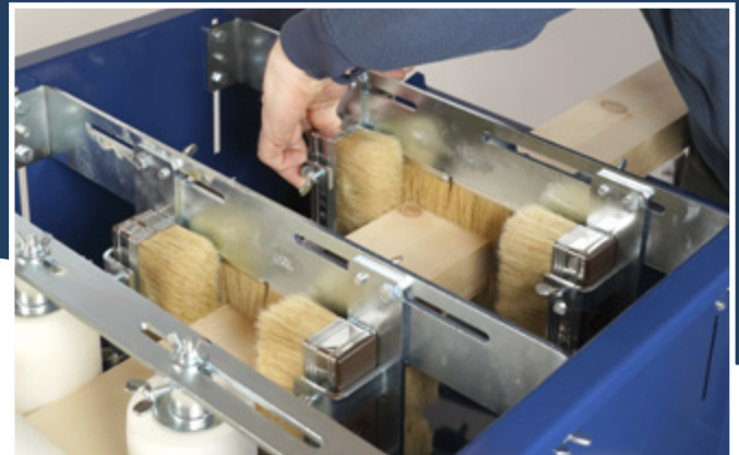
Kalibrierung der Bürsten* für optimale Endbearbeitung.
